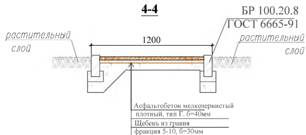
Асфальтобетон мелкозернистый плотный, тип Г, б=40мм
