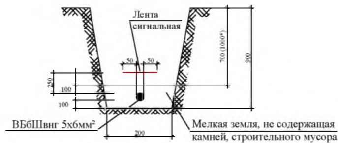
Расположение кабеля в земле
