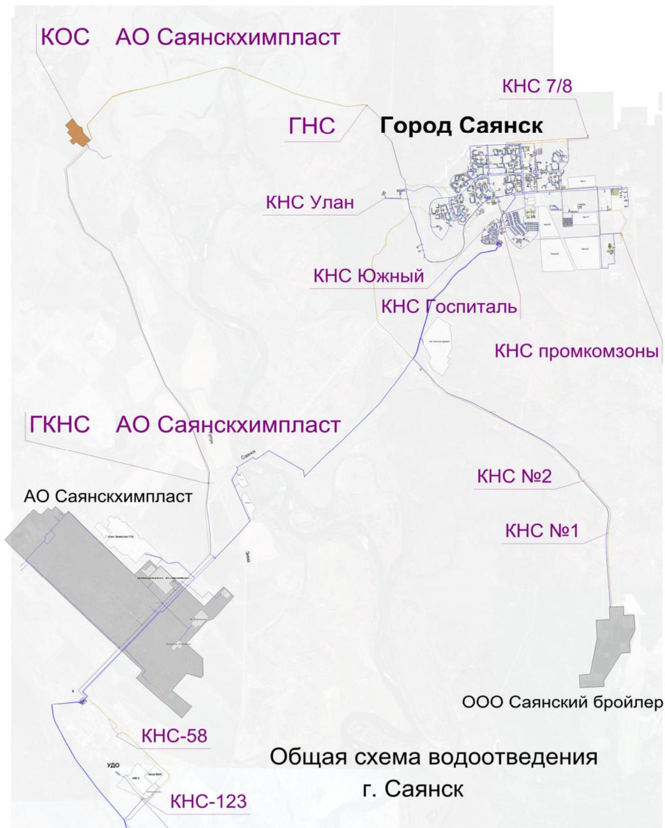
**Рис. 2.1** Общая схема централизованного водоотведения г. Саянск
